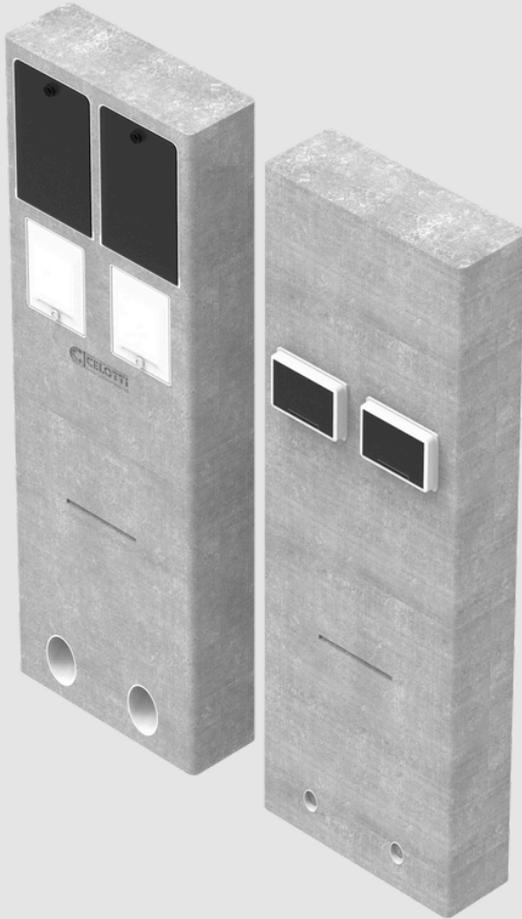
PILAR DE LUZ TIPO "PAVIUSO", DISEÑADO PARA ALOJAR DOS PUNTOS DE MEDICIÓN MONOFÁSICOS O TRIFÁSICOS, CON ACOMETIDA Y SALIDA, SUBTERRÁNEA.
