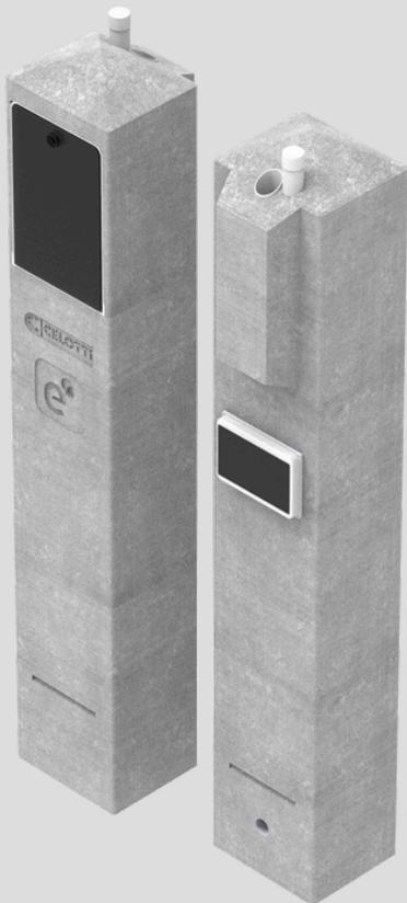
PILAR DE LUZ TIPO "MULTIUSO", DISEÑADO PARA ALOJAR UN PUNTOS DE MEDICIÓN TRIFÁSICOS, CON ACOMETIDA AÉREA Y SALIDA TANTO AÉREA COMO SUBTERRÁNEA.
